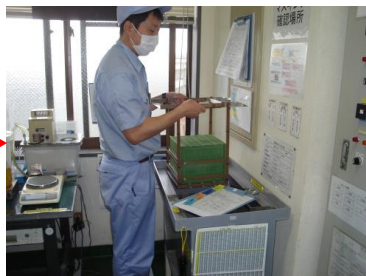
③ 専用置場から製品をハンドリングで前処理工程のクリーナーに投入する。
