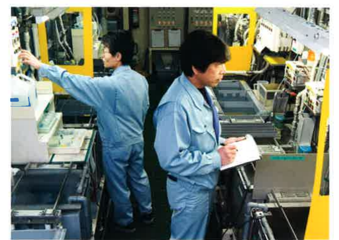
▲清川メッキ工業(福井県福井市)の工場。従業員は約220人で、写真は電子部品や機械などにメッキ加工(表面を金属の薄い膜でおおう)をおこなっているところ。0.4mm×0.2mm四方という小さな部品でもメッキできる技術をもっている。
