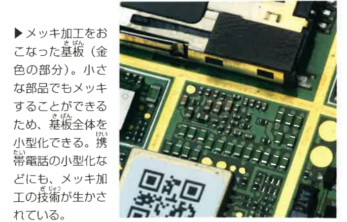
▲清川メッキ工業(福井県福井市)の工場。従業員は約220人で、写真は電子部品や機械などにメッキ加工(表面を金属の薄い膜でおおう)をおこなっているところ。0.4mm×0.2mm四方という小さな部品でもメッキできる技術をもっている。
